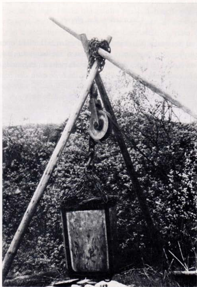
Chevalet ( gade ), avec tonneau ( tonê ), posé au-dessus du trou d'évacuation ( beur ) et utilisé pour évacuer les décombres et les petits morceaux de pierre ( fâhins ). ( Photo de l'auteur. )
