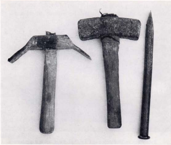
1. Le marteau à deux pannes ( lu mârte à deûs pènes ). — 2. La massette ( lu massète ). — 3. Burin étroit ( ponçon ) utilisé pour l'habillage des pierres.
