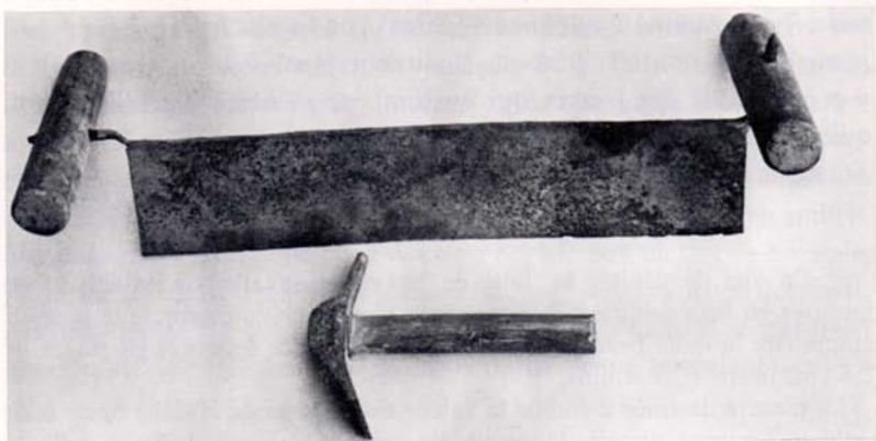
Scie ( leûp ) et marteau pour créneler la scie ( mârtê d' crîns ). (Photo de l'auteur.)
